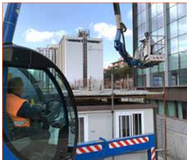
Utilizzo di piattaforma aerea autocarrante articolata.
